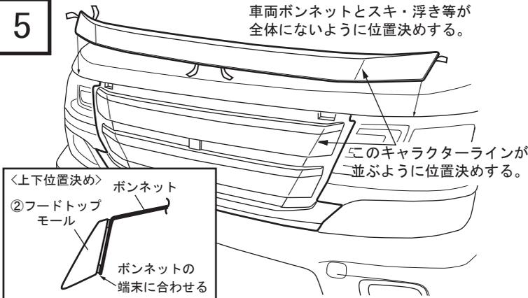
1. 図を参考にして、ボンネットを開けて、②フードトップモールを車両ボンネットにセットして、取付位置の確認をしてください。
