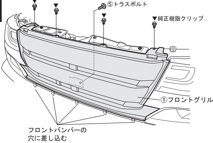
1. 図を参考にして、ボンネットを開けて、①フロントグリル下側の突起部を純正フロントバンパーの穴に差し込んでセットしてください。
