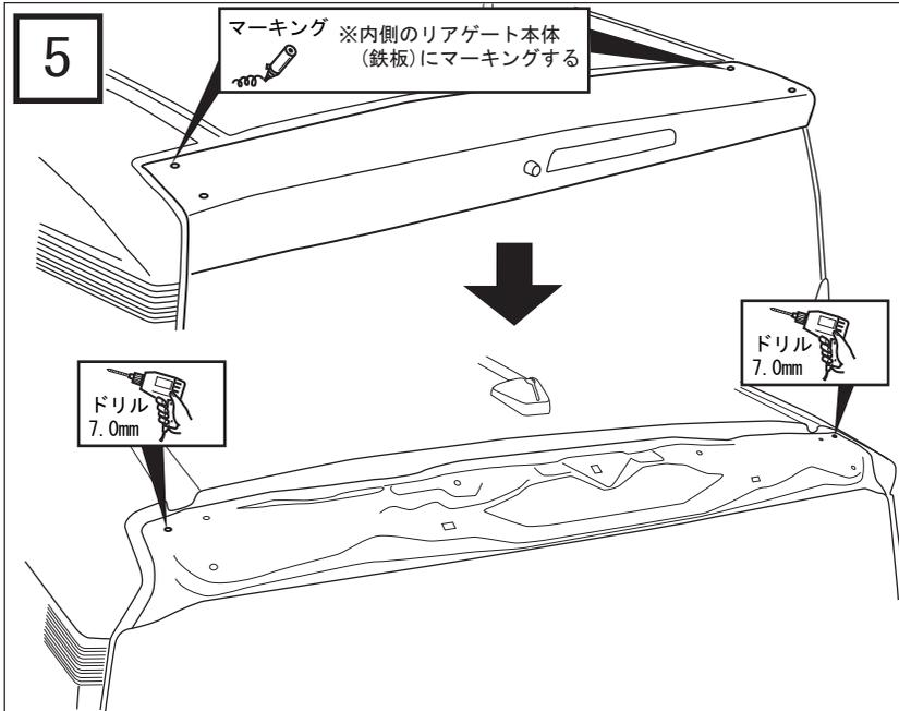
1. 図を参考にして、樹脂パネルの前側の穴位置を内側のリアゲート(鉄板)にマーキングして樹脂パネルを再度外してください。
