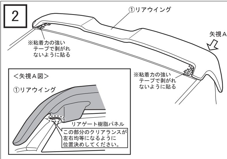
1. 図を参考にして、①リアウイングを車両に取付位置を確認して仮セットしてください。(左右が均等になるように注意！)
